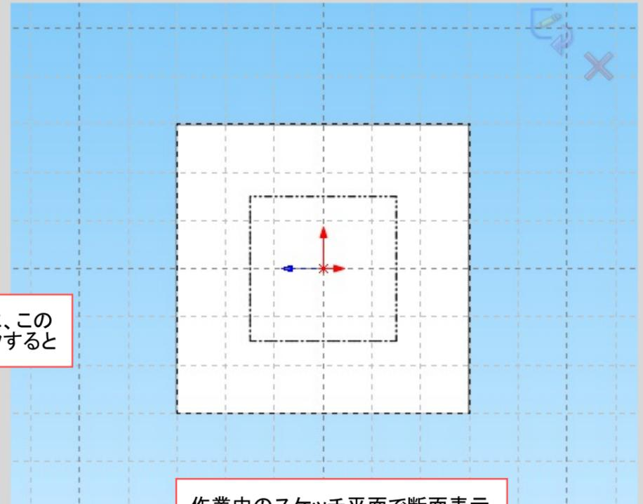
作業中のスケッチ平面で断面表示するので、垂直に表示のまま周囲の形状を参照できる。
